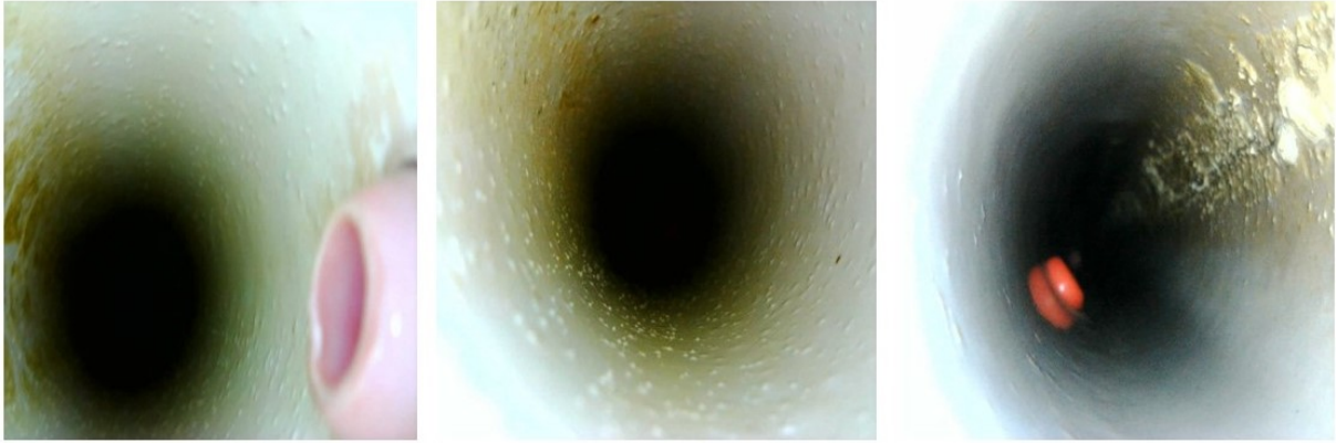
Resim 4 Uygulama sonrası su hattı içi biyofilm tabakaları
